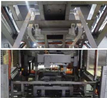
Está constituido por **dos servomotores con reductora**, uno de ellos ubicado en la parte superior, para **realizar el proceso de elevación y descenso del carro**, y el segundo de menor tamaño, ubicado en el centro que permitirá **girar el carro 360°**.
